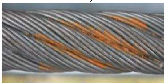
Slika 4.19: Korozija med prameni abstrahirana)
