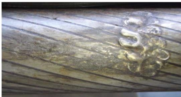
Slika 2.14: Mesto udara na spodnji strani vrvi
