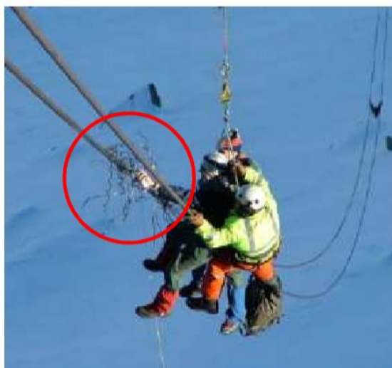
Slika 2.8: Poškodbe na nosilni vrvi [6]
