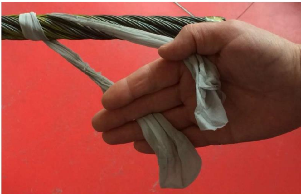
Slika 5.20: Varno držanje najlonske nogavice
