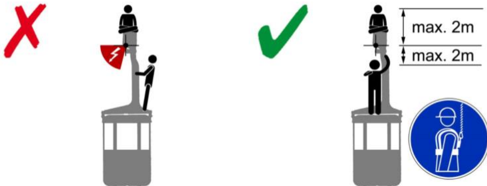
Slika 11: Slab delovni položaj med pregledom nosilne vrvi, cca. 45° vrvi ni mogoče videti
