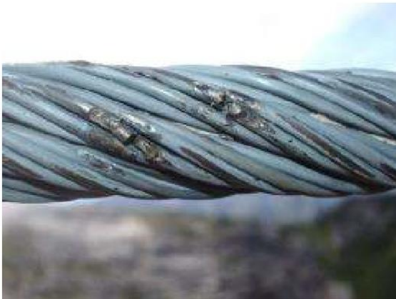
Slika 4.2: Martenzitne strukture s stopljenimi žičkami
