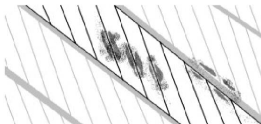
Slika 4.19: Korozija med prameni abstrahirana)
