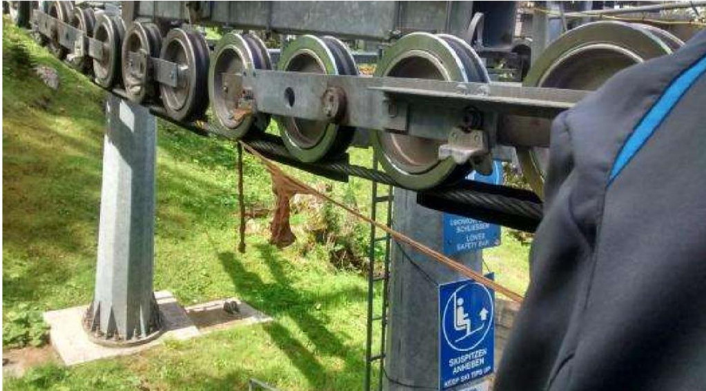
Slika 5.19: Nogavica, ki se je zataknila na vrv in prišla pod kolesa
