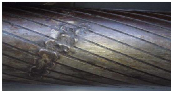
Slika 2.15: Mesto udara/izstopa strele ob strani vrvi
