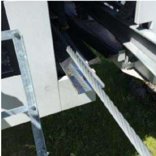
Slika 3.12: Zrcalo v standardizirani moduli postaji enovrvne krožne žičnice (pogled iz izven postaje)
