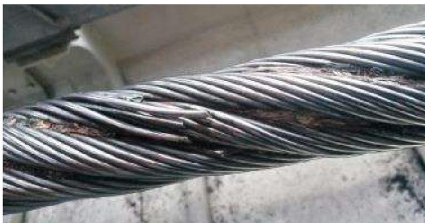
Slika 2.3: Porušitev na spojnem mestu do lomov žičk
