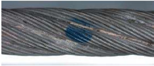
Slika 4.5: Udar strele 1,0xpremer pramena
