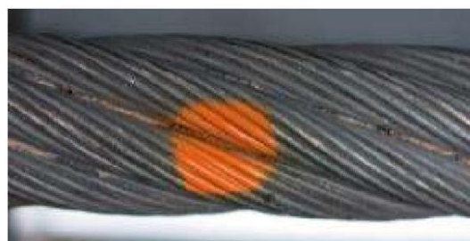
Slika 4.18: Korozija preko več pramenov abstrahirana
