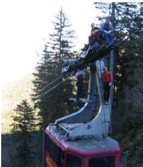
Slika 3.8: Vizualni pregled nosilne vrvi na lestvah, platformi, sedežu in tekalu
