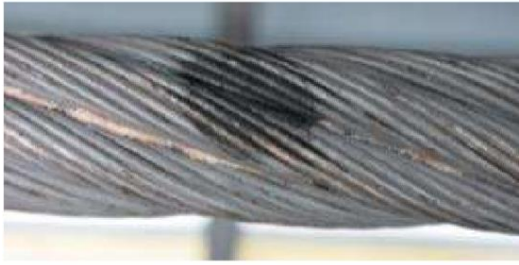
Slika 4.4: Udar strele 1,5xpremer pramena
